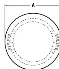
Version ignifugée de notre gamme NH430. Meilleure résistance aux UV. Les clips de blocage permettent une utilisation dans des panneaux de 0,8, 1,6, 2,4 et 3,2 mm sauf pour nos références NH431-2606 et NH431-2616.
