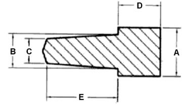
Assure une épargne autour du trou à protéger - gain de temps dans les opérations de masquage. Sa forme conique s'adapte à tous les trous. Recommandé pour les applications peinture et traitement de surface. Réutilisable
