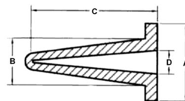
Assure une épargne autour du trou à protéger - gain de temps dans les opérations de masquage. Creusé pour le rendre plus léger et plus économique. Sa forme conique s'adapte à tous les trous. Recommandé pour les applications peinture et traitement de surface. Réutilisable
